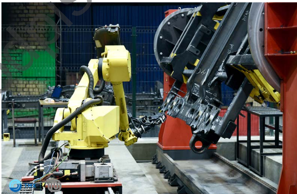
Роботизированный участок контроля сварных швов на ТВЗ
